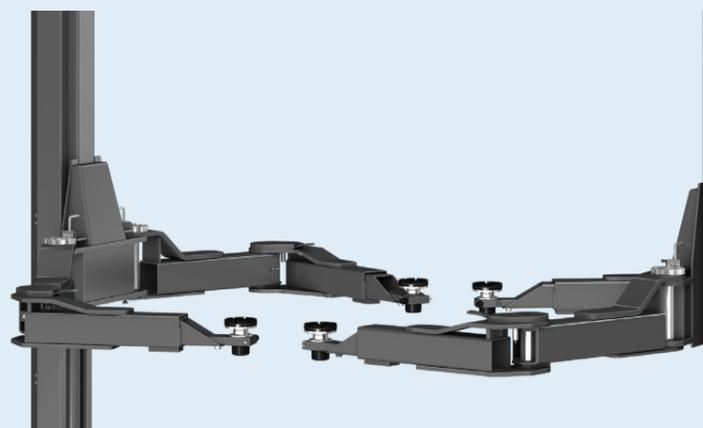
Bras double-articulés DG: Flexible et ergonomique, atteignent 100% des points d'ancrage. Système de verrouillage pneumatique disponible en option à partir de 6,5 tonnes sur la série HDL
