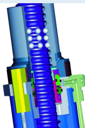
Le SST est la SAFETY STAR TECHNOLOGY, une technologie brevetée NUSSBAUM. Elle assure la synchronisation des colonnes au dixième de millimètre.
