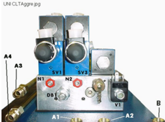
Fig. 6: SV1 & SV2 posiciones de las válvulas de doble asiento.
