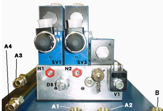
Bild 6: SV1 & SV2 Positionen der Doppelsitzventile
