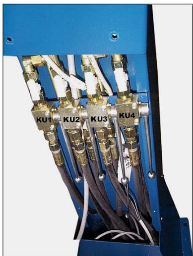
Fig 2: Llave esférica para igualar/ nivelar pasarelas del elevador
