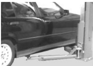
Bild 1: Tragteller unter die vom Fahrzeughersteller vorgesehenen Punkte ansetzen.
