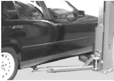
fig.1 : fixer les plateaux réglables aux endroits prévus par le fabricant du véhicule.
