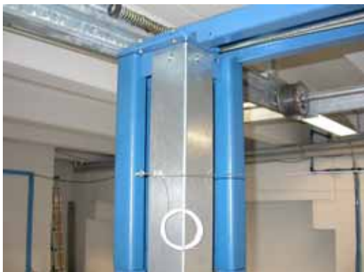
Bild 7: Obere Hubbegrenzung (Seil) nach Montage der Zylinderabdeckung an der Augenschraube anbringen.
