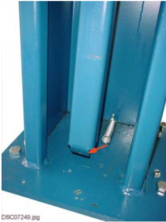
Bild 6: Zugfedern an den Klinkenleisten einhängen
