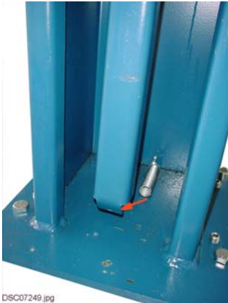
Bild 6: Zugfedern an den Klinkenleisten einhängen
