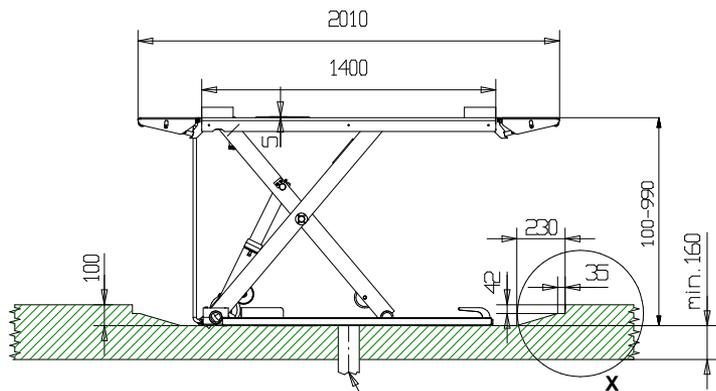
Wasserabfluss DN100 in der Vertiefung empfohlen
