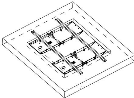
Hebebuehne einsetzen, ausrichten und verduebeln
