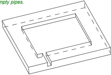
Wannen einsetzen, gegen eindruecken aussteifen, Leerrohre montieren
