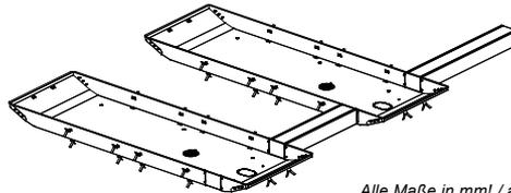
Leerrohre mit ausreichend Ueberstand. Erst nach einsetzen und betonieren der Wanne, sind die Leerrohre entsprechend zu kuerzen und abzudichten
