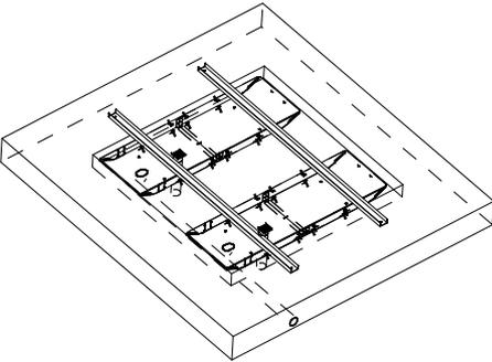
Hebeuebne einsetzen, ausrichten und verduebeln
