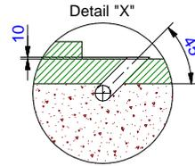
Leerrohre mit ausreichend Ueberstand. Erst nach einsetzen und betonieren der Wanne, sind die Leerrohre entsprechend zu kuerzen und abzudichten
