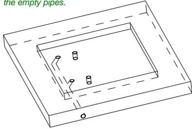
Wannen einsetzen, gegen eindruecken aussteifen, Leerrohre montieren
