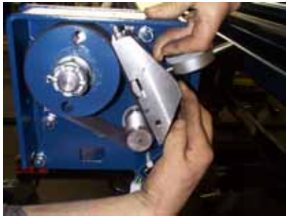
Bild 10: Messgerät am Riemen anlegen
