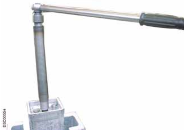
Bild 9: Abbildung kann abweichen. Lange Gewindehülse (erhältlich bei Ihrem Händler) aufschrauben und mit einem geeigneten Werkzeug (Schlüsselweite 24) im Uhrzeigersinn drehen. Den Hubschlitten ca. 5-10 cm absenken. Danach Vorgang am nächsten Hubschlitten wiederholen usw. Die Hubschlitten dürfen nur in Schritten jeweils 5-10 cm abgesenkt werden, bis die gesamte Hebebühne die unterste Position erreicht hat.
