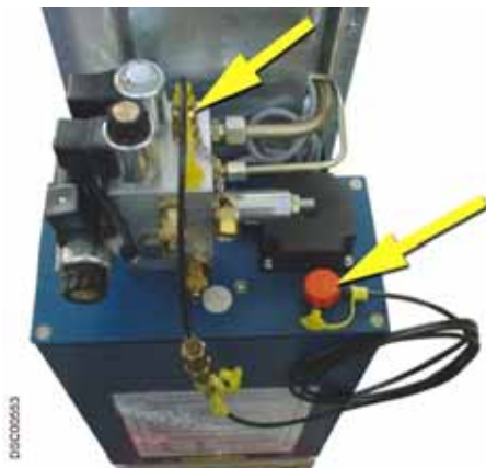
Bild 8: Abbildung kann abweichen. Der Deckel des Minimeßanschlusses und der Tankdeckel sind zu lösen. Die passende Minimeß-Hydraulikleitung ca. 500 mm lang (erhältlich bei Ihrem Händler) aufschrauben und das andere Ende in den Tank einführen.
