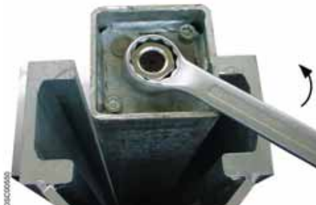
Bild 6: Abbildung kann abweichen. Die 2 konterten Muttern (Schlüsselweite 41) am oberen Ende des Hubschlittens in Pfeilrichtung lösen und entfernen. Dieser Vorgang ist an allen Hubschlitten durchzuführen.
