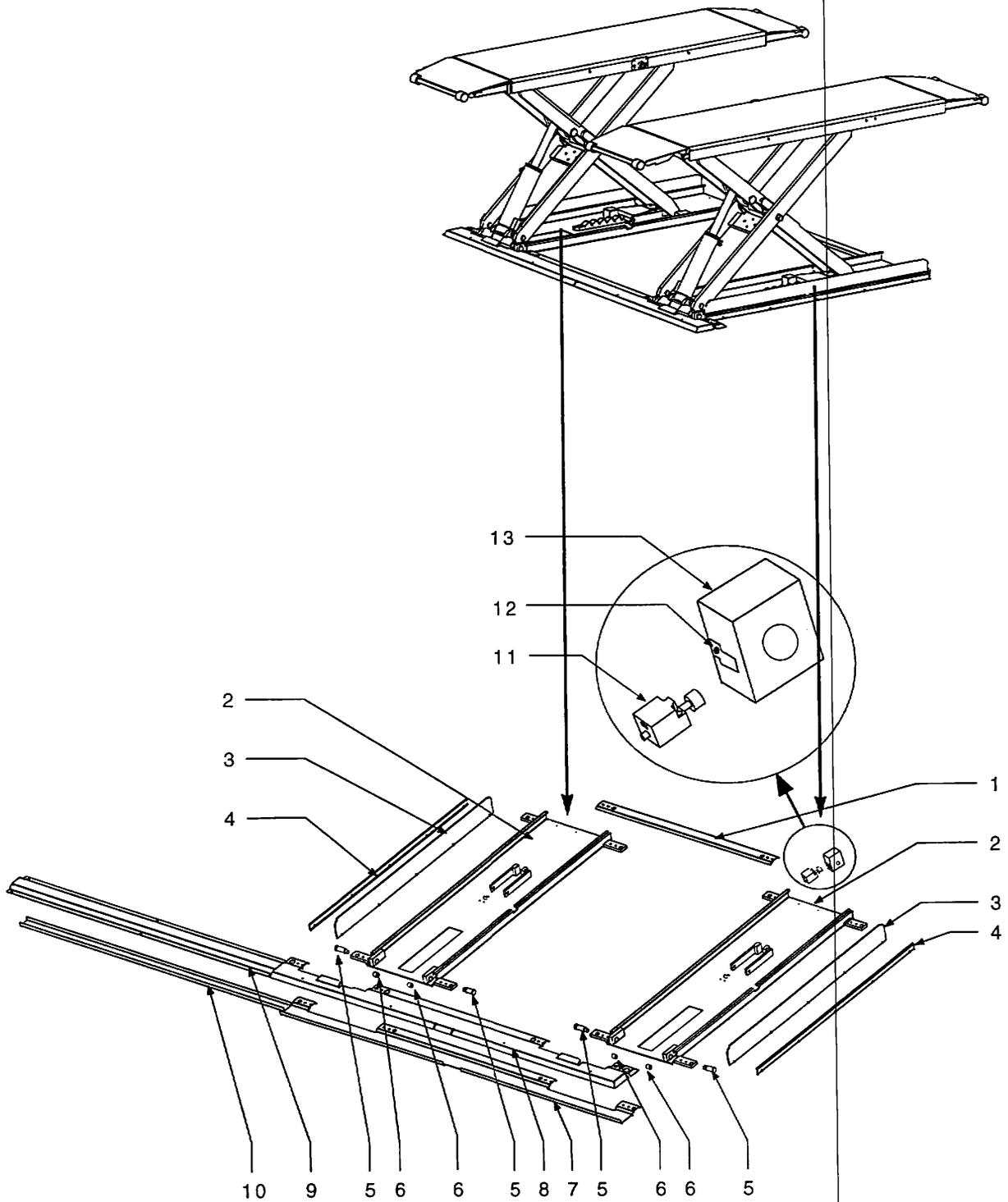
**Ersatzteilliste Bodenlager und Abdeckungen**
