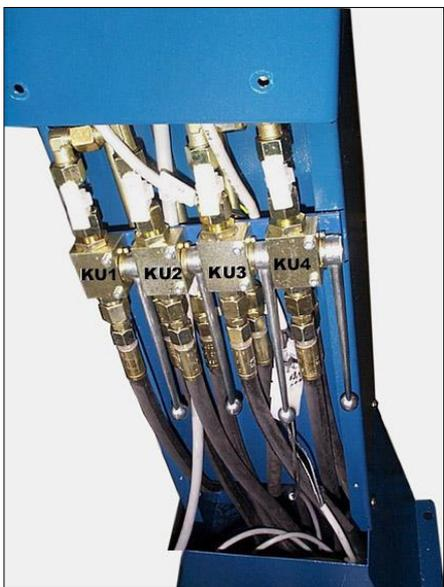
Bild 2: Kugelähne zum Ausgleichen der Hebebühne
