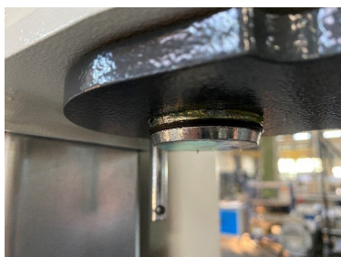
Fissaggio inferiore del bullone del braccio portante
