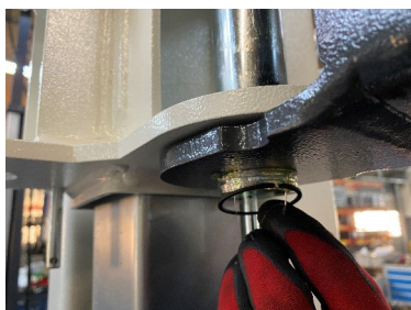
Montare l'anello di sicurezza nella parte inferiore
