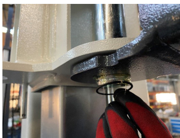
Mettre le circlip en bas
