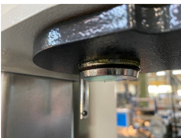
Untere Sicherung des Tragarmbolzens
