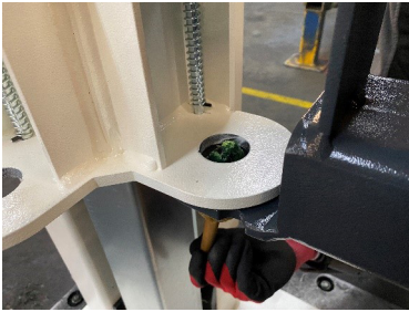
Untere Bohrung einfetten
