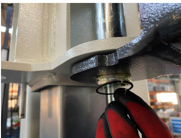
Sicherungsring unten anbringen
