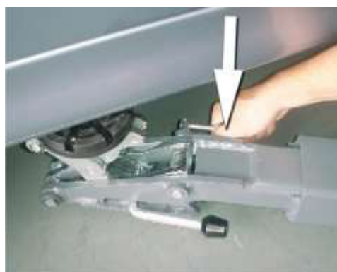
Immagine 3: Per sbloccare i piattini di alloggiamento bisogna premere la leva inferiore.
