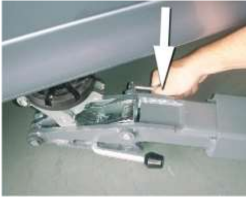
Figura 3: Para desencajar los platos de elevación se deberá presionar la palanca posterior.
