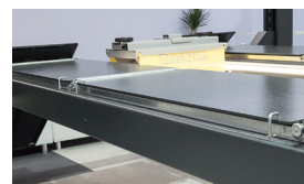
Doppelte Schiebeplatten zur Achsvermessung
