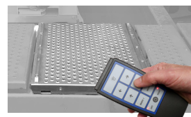
Gelenkspieltester mit Fernbedienung für 4.65 S
