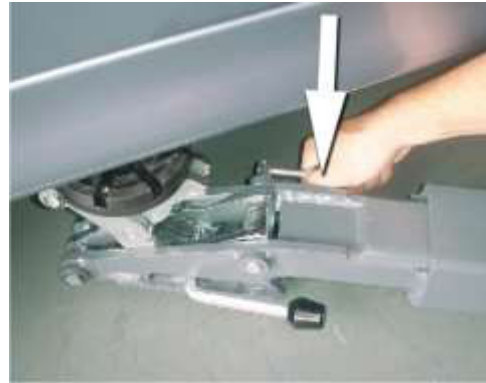
Figure 3 : Pour déverrouiller les plateaux porteurs, le levier arrière doit être actionné.
