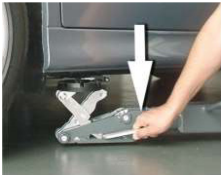
Bild 2: ggf. Tragteller durch Drücken des Hebels an den Aufnahme Punkten ansetzen.
