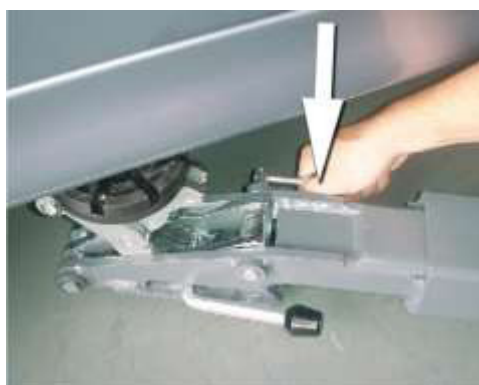
Figure 3 : Pour déverrouiller les plateaux porteurs, le levier arrière doit être actionné.
