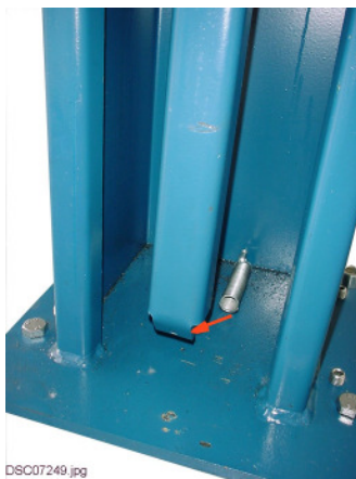
Bild 6: Zugfedern an den Klinkenleisten einhängen
