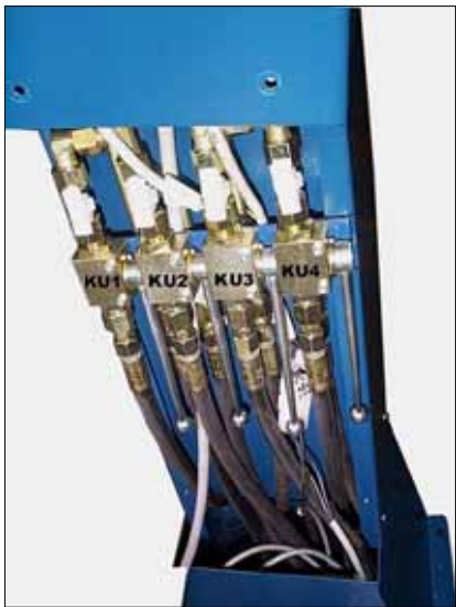
Bild 2: Kugelhähne zum Ausgleichen der Hebebühne
