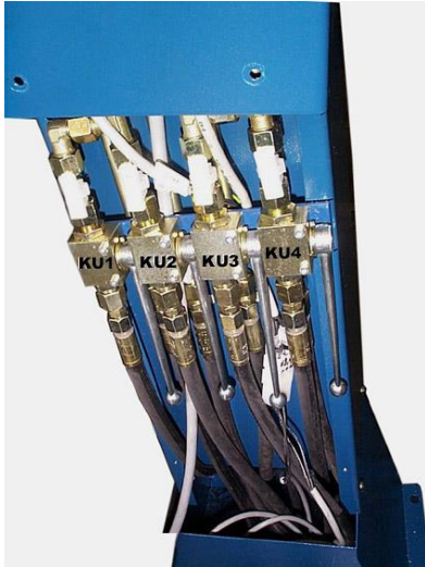
fig 2: robinets à boisseau spherique
