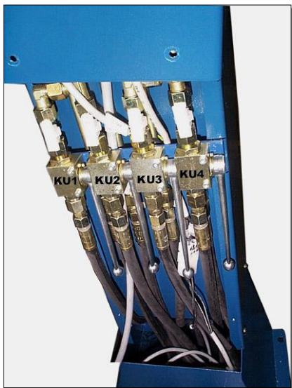
Bild 2: Kugelhähne zum Ausgleichen der Hebebühne
